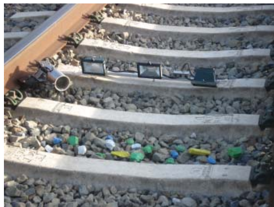
Piedras de balasto identificadas con colores para su grabación en video al paso del tren.
