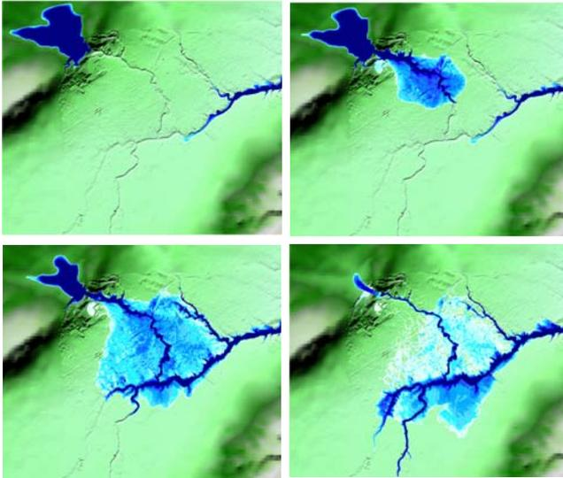
Ejemplo de simulación de rotura de presa
